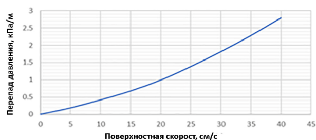
Перепад давления на активированном угле SORSORB CAG-D 4 мм (Температура 20 градусов цельсия, 1 Бар)
